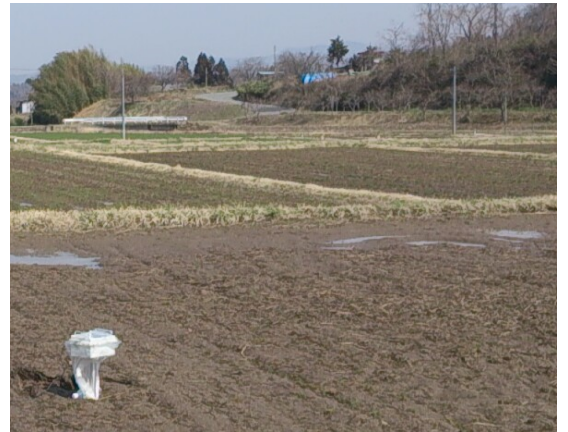
深さ分布測定器 2014年3月28日試験データ 1cm 2 CsI検出器 2cm間隔 900秒測定 ROI範囲：Cs134,Cs137
